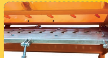
Dosierschiene - zur Reinigung klappbar Metering flap - hinged for cleaning Přístup k čištění usnadňuje sklopná dávkovací clona
