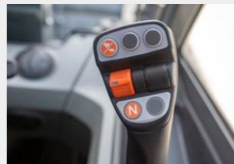
Pohodlný joystick: Přímo na joysticku lze přepínat mezi režimy zajíc a želva.
