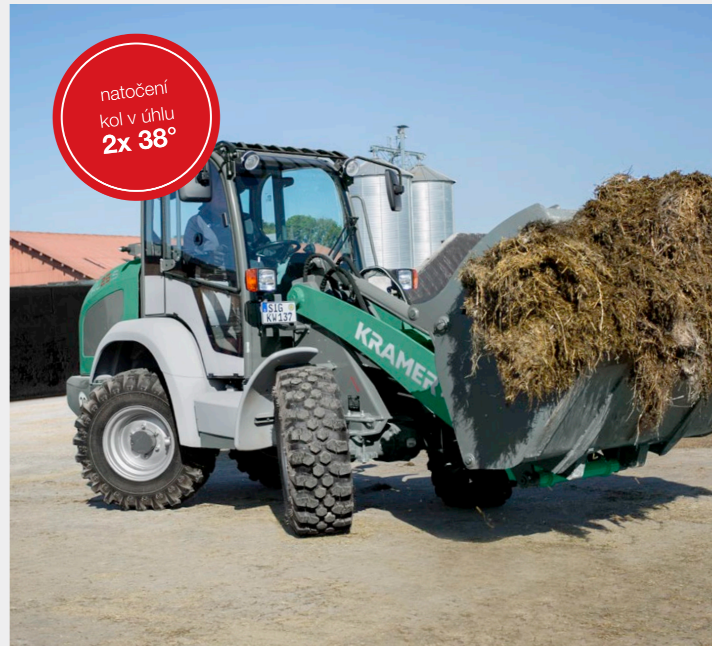
Řízení všech kol: oceníte zejména v úzkých prostorech
