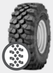
Víceúčelový vzorek - Michelin KL19.5 - KL25.5T
