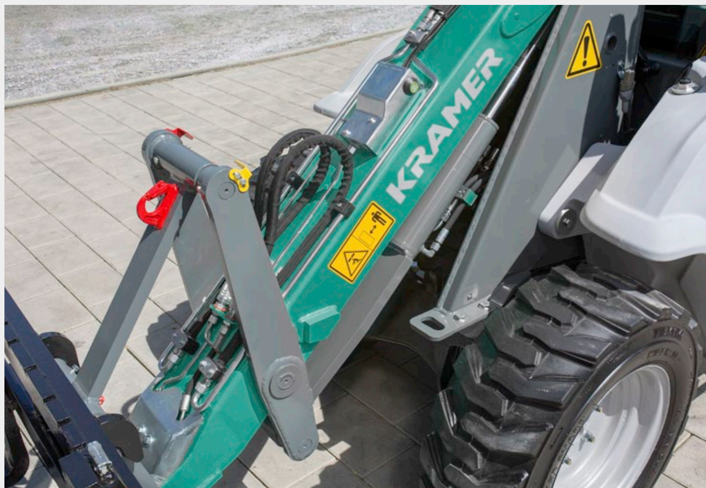
Robustní výložník s Z-kinematikou, vizuální indikací pozice a volitelným jeřábovacím hákem.
