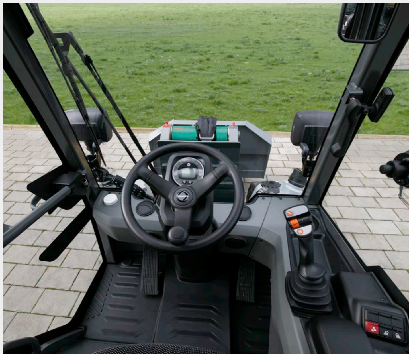
Pohodlný joystick: Přímo na joysticku lze přepínat mezi režimy zajíc a želva.
