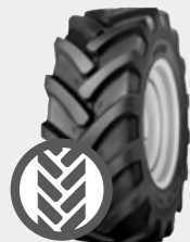
Šípový vzorek - Mitas Premium KL18.5 - KL25.5T
