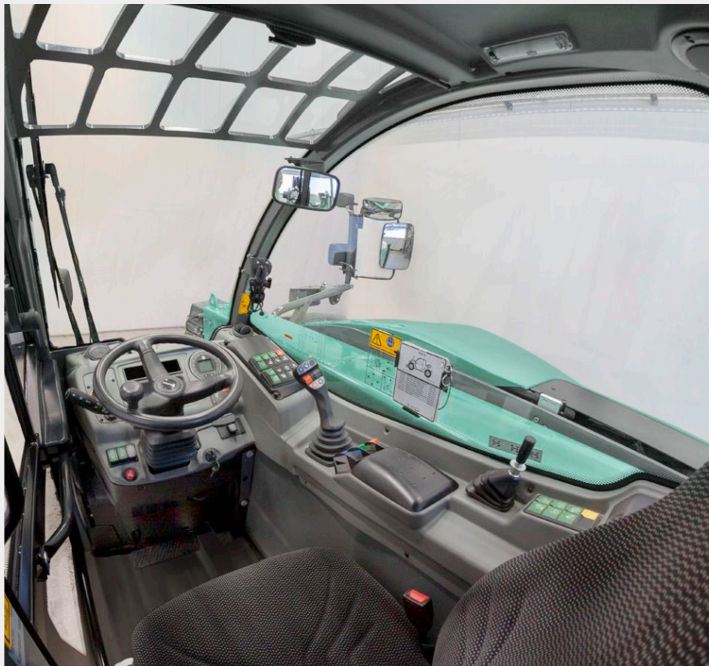
Dobrý výhled doprava díky velkému pravému oknu a nízké poloze teleskopického výložníku
